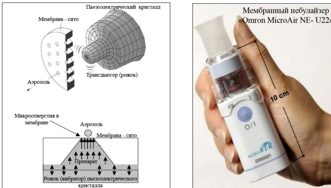
Рисунок 11. Схема работы мембранного небулайзера MicroAir NE-U22 (Omron)
